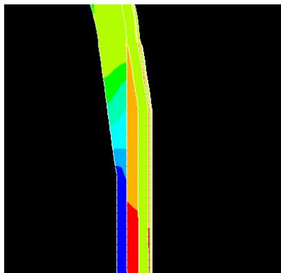
图 13 结构过渡段的应力分布云图
