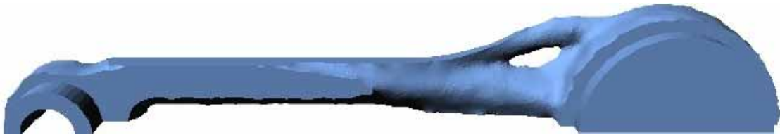
图9 带制造工艺约束条件的拓扑优化结果
