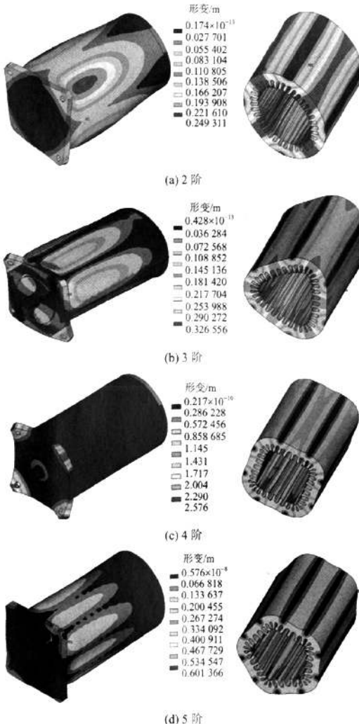
图5 电机结构模态振型的有限元仿真结果 Fig. 5 FEM results of mode shapes for the motor
